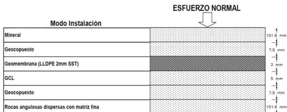
Figura 4 Esquema del ensayo de punzonamiento
