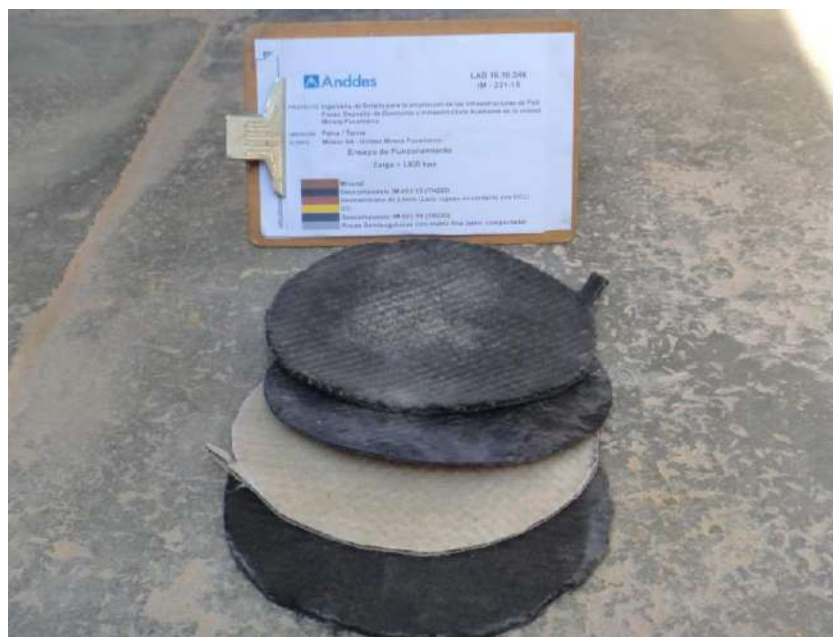
Figura 5 Ensayo de punzonamiento a la geomembrana
